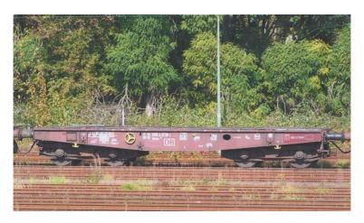
Dieses Modell hat ein Rahmenteil ohne Überfahrfläche. Die Gattung hat 4 normale Seilhaken (und keine Ösen) die angeordnet sind Äußern die Wagenzapfen Versteifung, unten der Rahmen.
