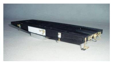
Auf jede Stirnseite sind 2 solide Bindehaken angeordnet am Außenseite des Puffers, aber keine Kupplungsmund.
